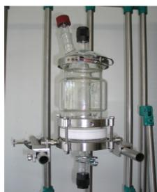
AMSI-Filtereinheit DN 100 aus Boro 3.3, Mittelstück zylindrischer Teil freibearbeitbar aus:
